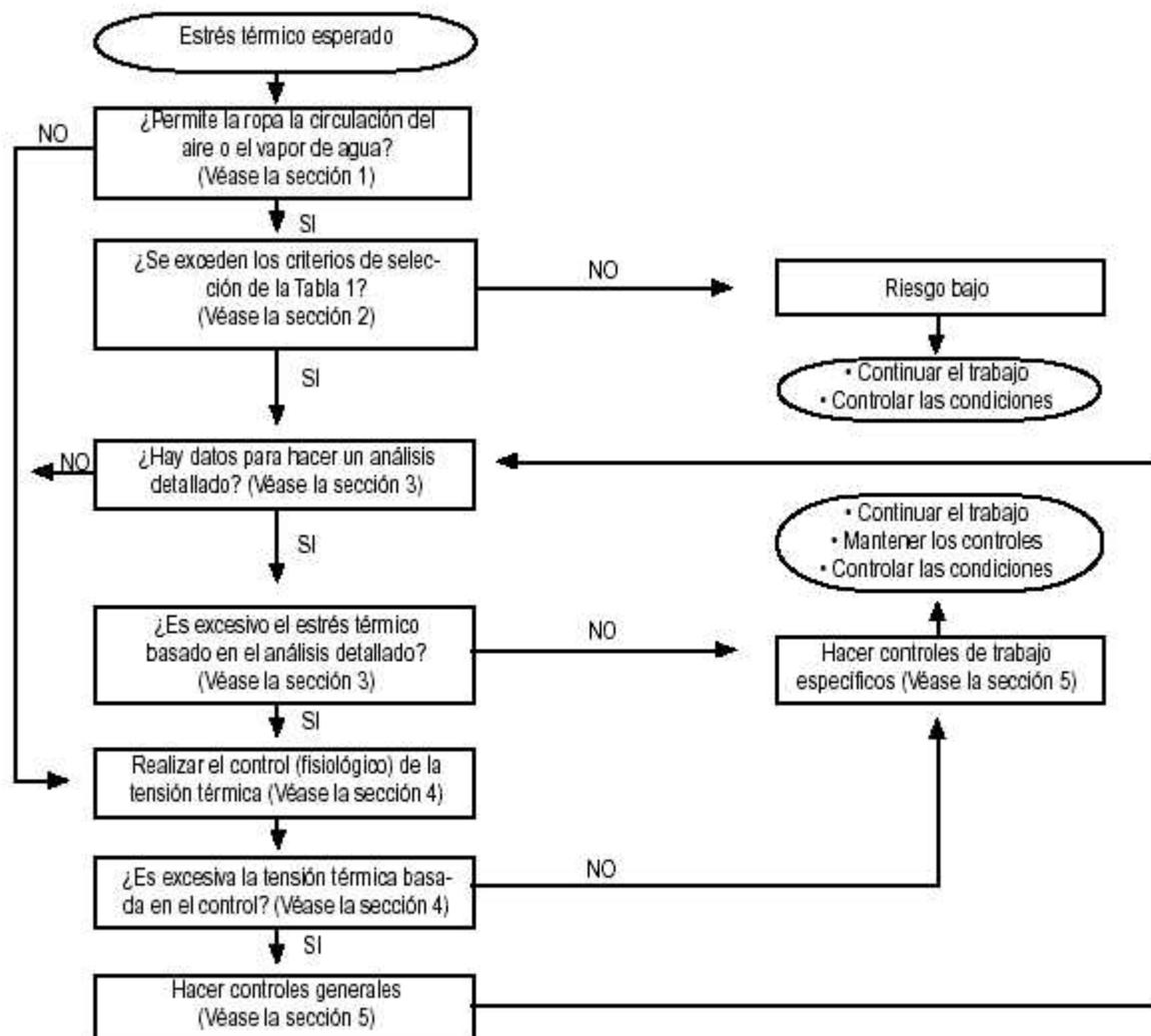
Figura 1. Esquema de evaluación para el estrés térmico.
