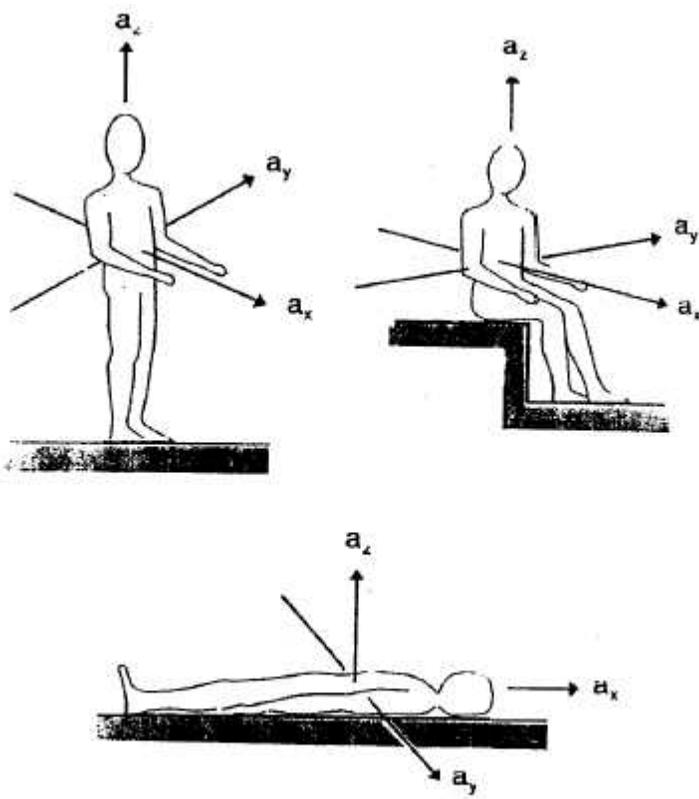
Figura 3: Sistema de coordenadas biodinámicas para medir las aceleraciones (adaptado según ISO 2631).  $a_x$ ,  $a_y$ ,  $a_z$  = aceleración en la dirección de los ejes, x, y, z: eje x dirección espalda-pecho; eje y dirección derecha-izquierda; eje z dirección pies-cabeza.
