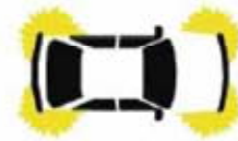
Emergencia: cuatro luces amarillas intermitentes, indican la detención del vehículo.
